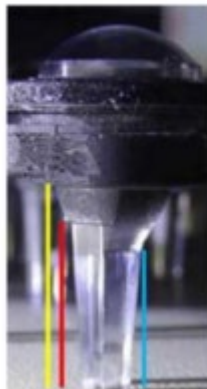
Abbildung 4: Sammellinse mit Lichtleiterstab, Trägerplatte und LED-Platine
